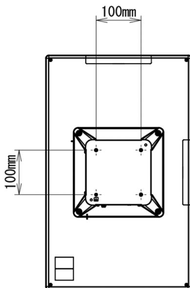
M4 のネジで固定します。締付けトルクは 0.7~0.8N・m です。
